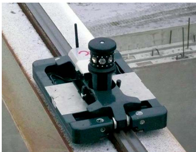
Прибор для контроля состояния рельсового пути ROBORAIL
